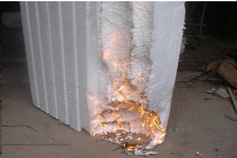
بلوک یونولیتی بعد از پنج ثانیه اشتعال
