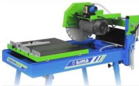
شکل ۲- نمایی از دستگاه برش کلوخه‌های سنگی
