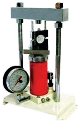
شکل ۱- نمونه ای از دستگاه اعمال بار فشاری در آزمایش برزیلی.
