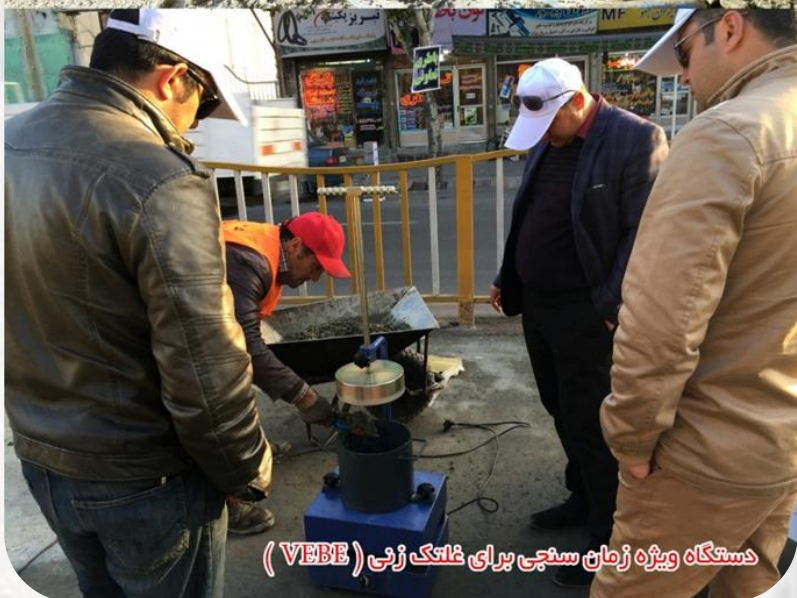
دستگاه ویژه زمان سنجی برای غلتک زنی (VEBE)
