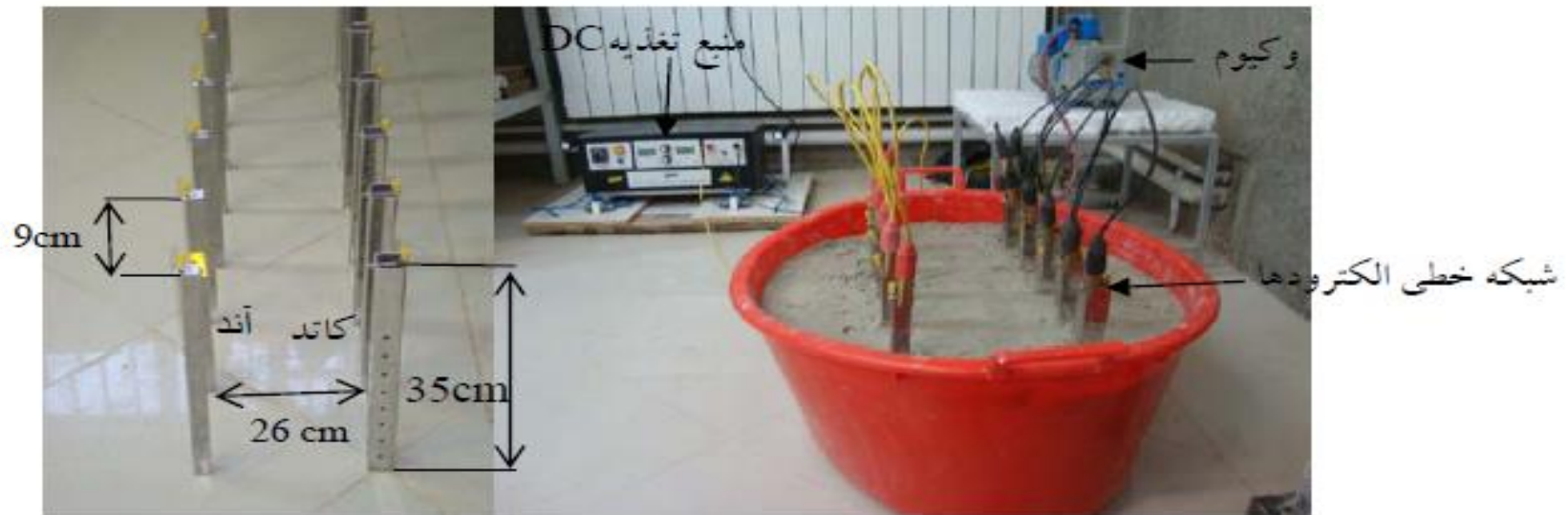
شکل ۱- نمایی از دستگاه الکترواسمزی نیمه صحرائی و چینش الکتروودها
