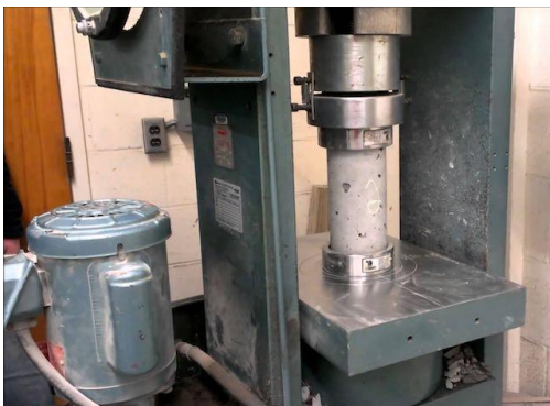
ب) دستگاه انجام آزمایش مقاومت فشاری نمونه بتنی
