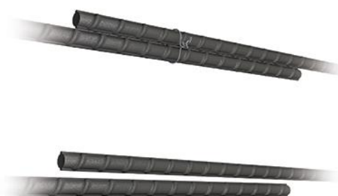
وصله پوششی غیر تماسی Noncontact lap splices
