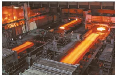
شکل ۳ ▲ نورد گرم ورق فولادی
