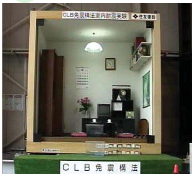
مدل سازه جدا ساز لرزه ای روی میز لرزان
